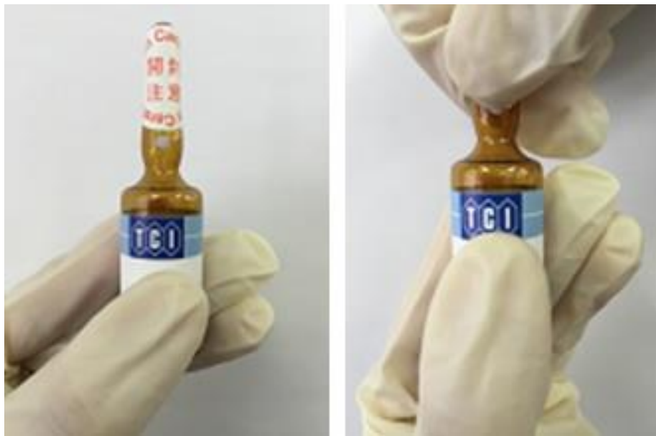
Noktalı ampullerin başının koparılması için uygun tutuş yöntemi
